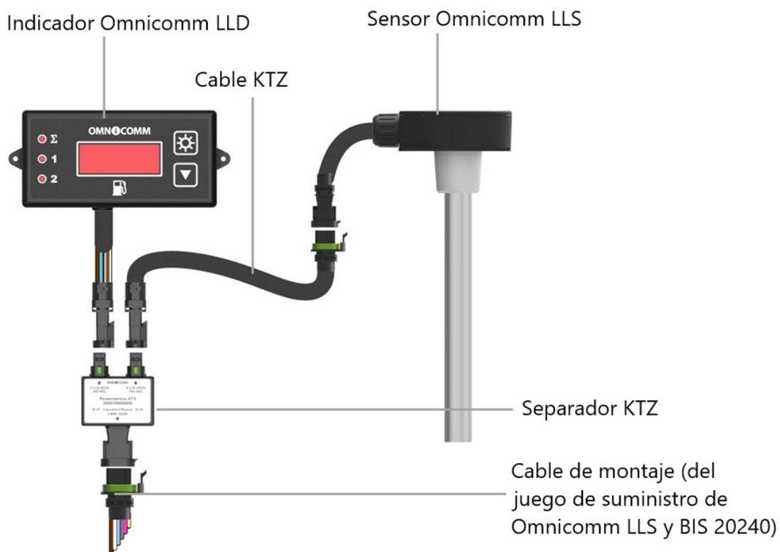
Si es necesario conectar dos sensores Omnicomm LLS, se recomienda usar dos divisores KTZ y dos cables KTZ.
