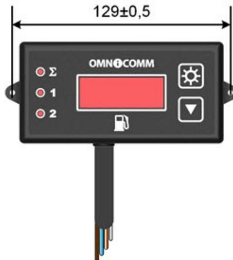
Al instalar el indicador de volumen de combustible Omnicomm LLD con el uso de tornillos autorroscantes, perforo dos orificios de fijación con un diámetro de 2.5 mm
