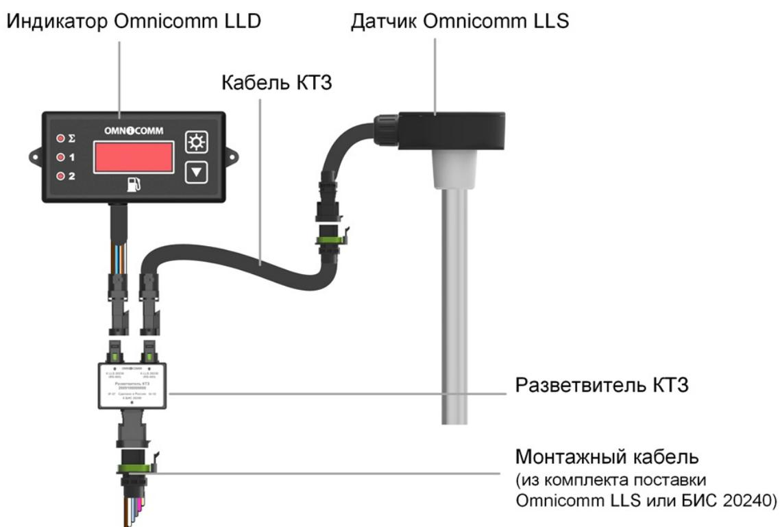
При необходимости подключения двух датчиков Omniconm LLS рекомендуется использовать два разветвителя КТЗ и два кабеля КТЗ.
