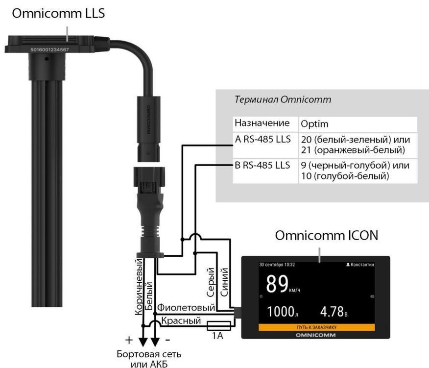
Подключение нескольких датчиков уровня топлива Omnicomm LLS производится параллельно по интерфейсу RS-485.
