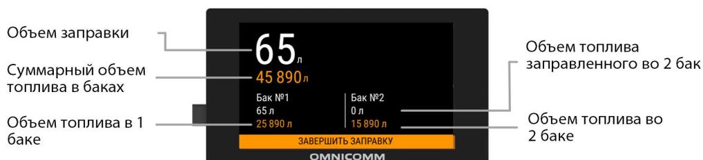
В процессе заправки на дисплее Omnicomm ICON отображается суммарный объем заправленного топлива и количество литров для каждого бака отдельно.
