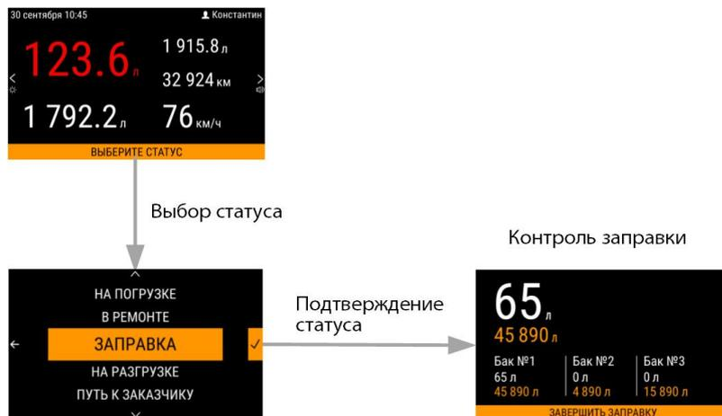
В процессе заправки на дисплее Omnicomm ICON отображается количество литров для каждого бака отдельно и суммарное количество литров, заправленного топлива.
