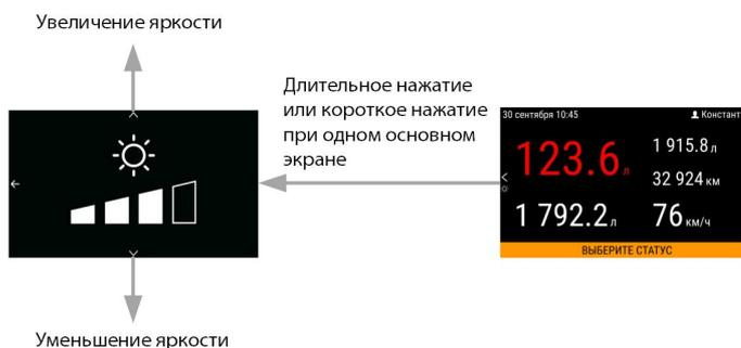
Выход из настройки яркости и переход к основному экрану производится автоматически в течение нескольких секунд или по нажатию левой кнопки.
