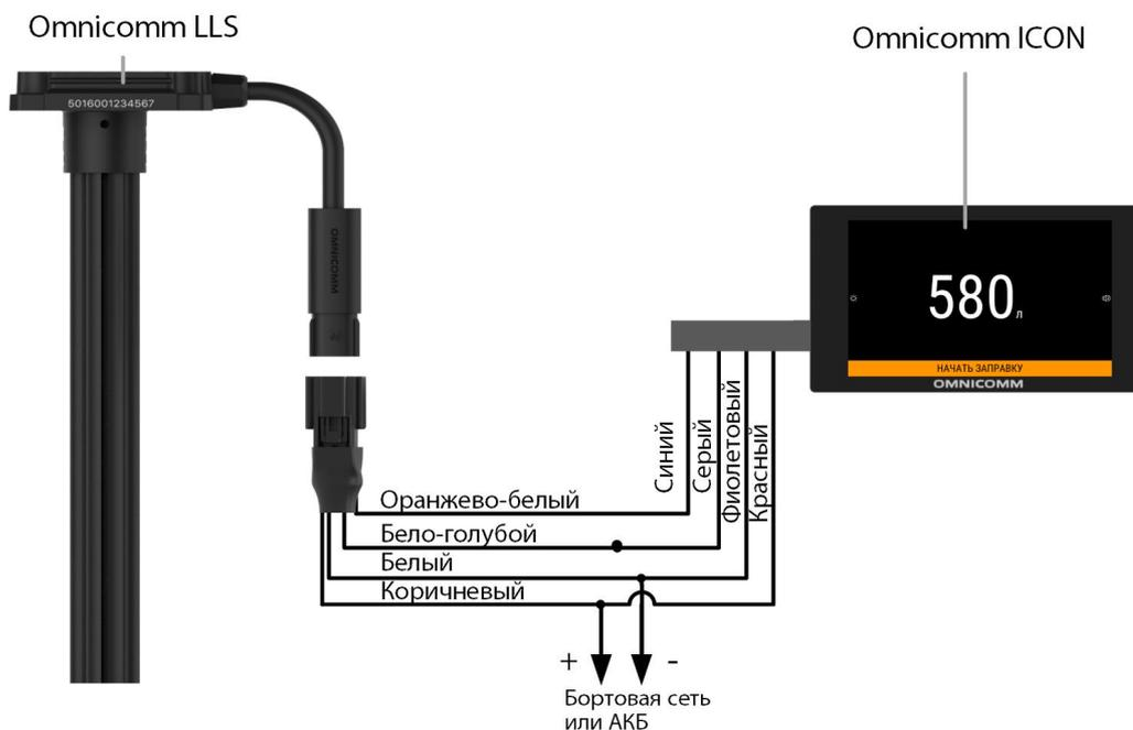
Подключение нескольких датчиков Omnicomm LLS производится параллельно по интерфейсу RS-485 согласно схеме:
