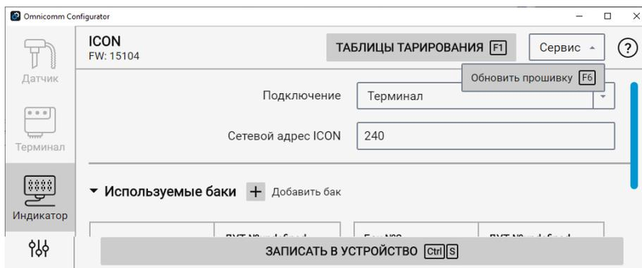
Откроется окно, в котором выберите файл встроенного программного обеспечения.
