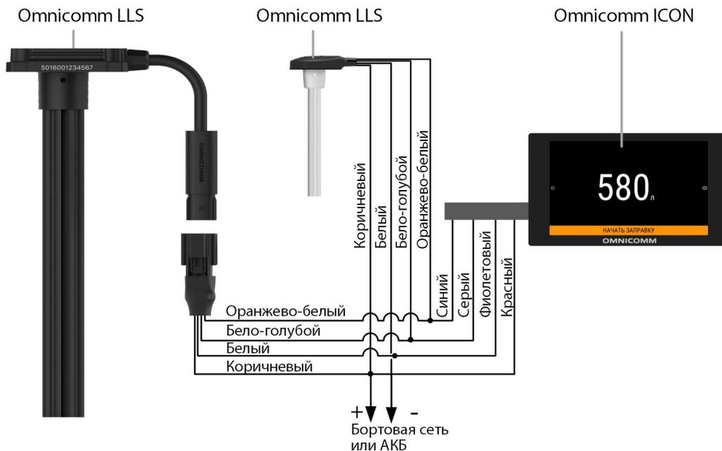
Подключение терминала Omnicomm Profi к дисплею Omnicomm ICON производите согласно схеме:
