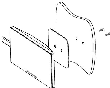
При использовании идентификации с помощью RFID карт прикрепите держатель RFID к дисплею саморезами. Для этого снимите пластину, отвинтив саморезы отверткой PH1.
