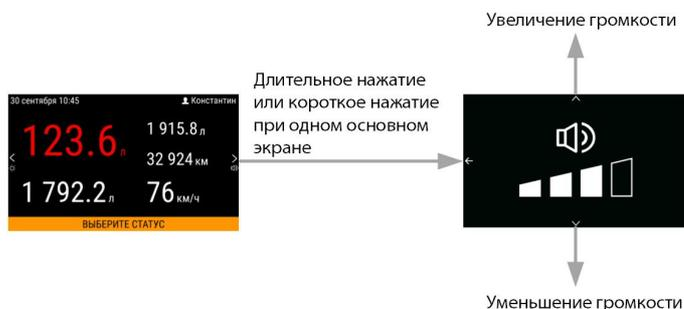
Выход из настройки громкости и переход к основному экрану производится автоматически в течение нескольких секунд или по нажатию левой кнопки.
