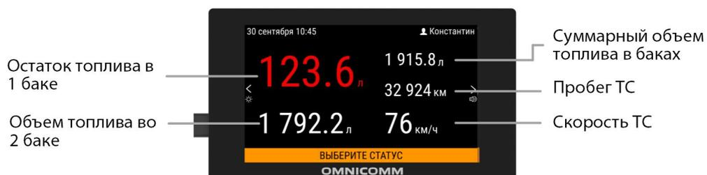
При снижении объема топлива ниже порогового значения, остаток топлива выделяется красным и будет произведен звуковой сигнал.
