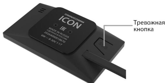
При включенном питании и нажатии на тревожную кнопку дисплей Omnicomm ICON передает событие о срабатывании по интерфейсу RS-485.
