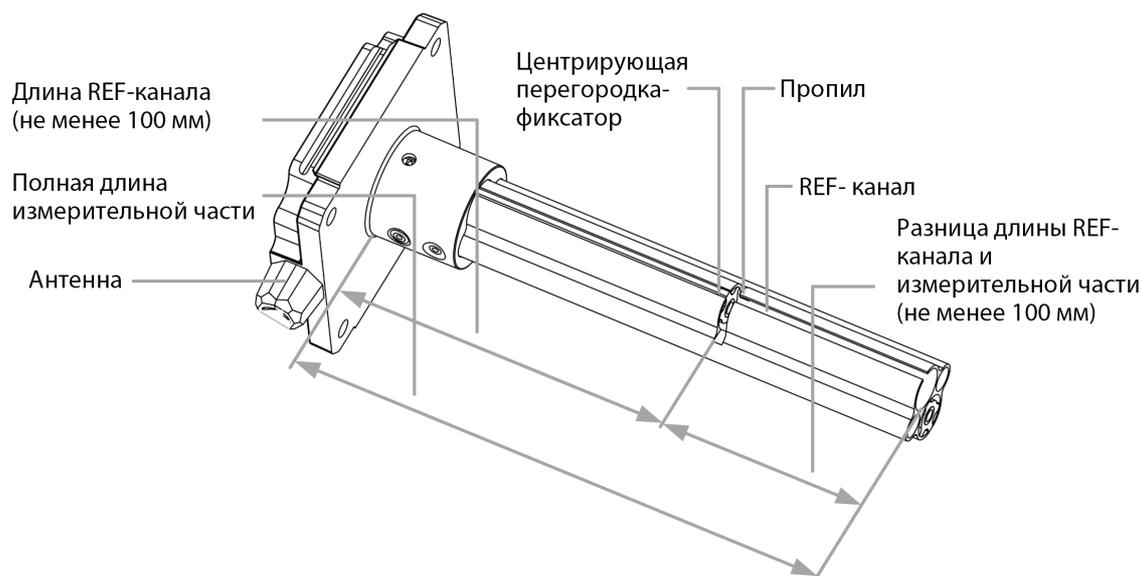
2. Установите центрирующую перегородку в измерительную часть датчика на глубине 1 см.
