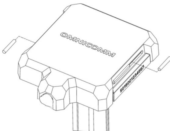
1. Установите кожух-пломбу на корпус датчика
